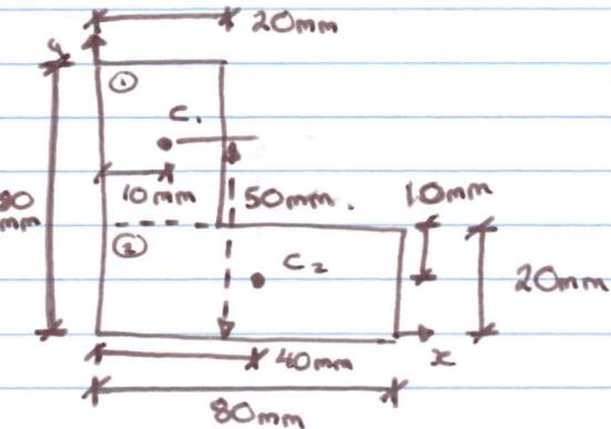
$$\begin{aligned} I_x &= \frac{1}{12} \cdot 20 \cdot 60^3 + \dots \\ &\quad + \dots 50^2 \cdot 1200 + \dots \\ &\quad + \dots \frac{1}{12} \cdot 80 \cdot 20^3 + \dots \\ &\quad + \dots 10^2 \cdot 1600 \Rightarrow 3.57 \cdot 10^6 \text{ mm}^4 \end{aligned}$$
