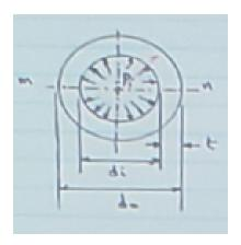
$$\sigma_r = \frac{p_i r_i^2 - p_o r_o^2}{r_o^2 - r_i^2} - \frac{(p_i - p_o) r_o^2 r_i^2}{r^2 (r_o^2 - r_i^2)}$$
