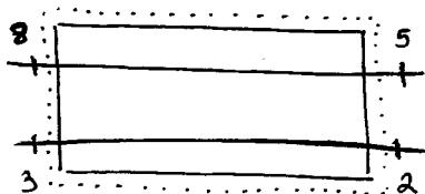
$$\dot{m}_A h_5 + \dot{m}_B h_3 = \dot{m}_A h_8 + \dot{m}_B h_2$$
