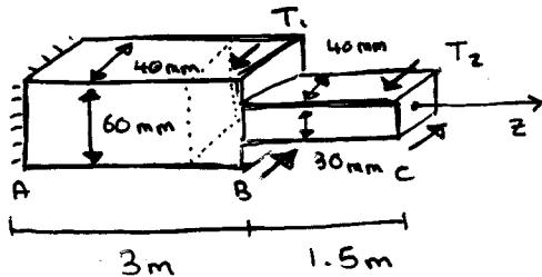
$$\begin{aligned}T_1 &= 750 \text{ N}\cdot\text{m} \\T_2 &= 400 \text{ N}\cdot\text{m} \\G &= 77.5 \text{ GPa} \\&= 77500 \text{ N/mm}^2\end{aligned}$$
